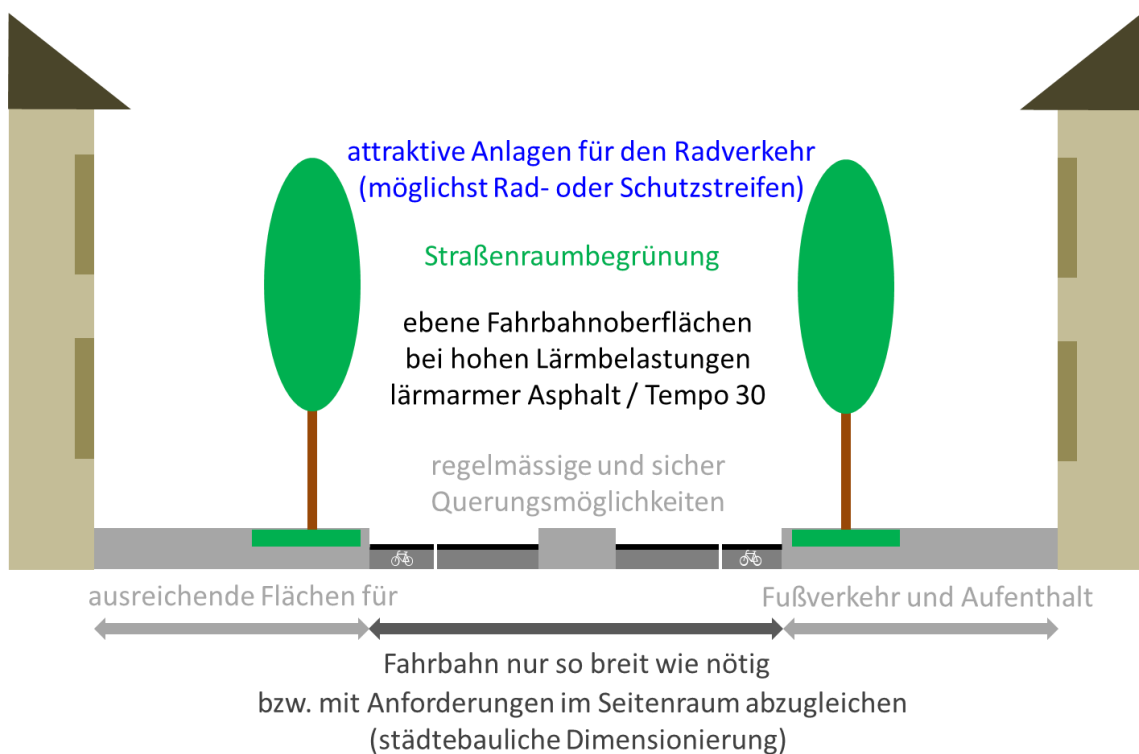
Abb. 23 idealtypischer Straßenquerschnitt im Sinne der Lärmreduzierung
